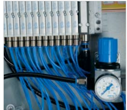
Ventilinsel mit integrierter Überdruckkontrolle
